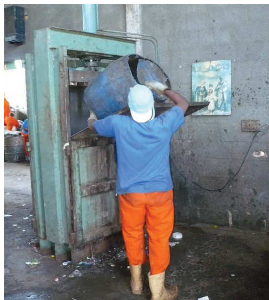
IMAGEM 44: Fotos 44a e 44b: Detalhe do recolhimento do material reciclável e prensa para transformação em fardos.
